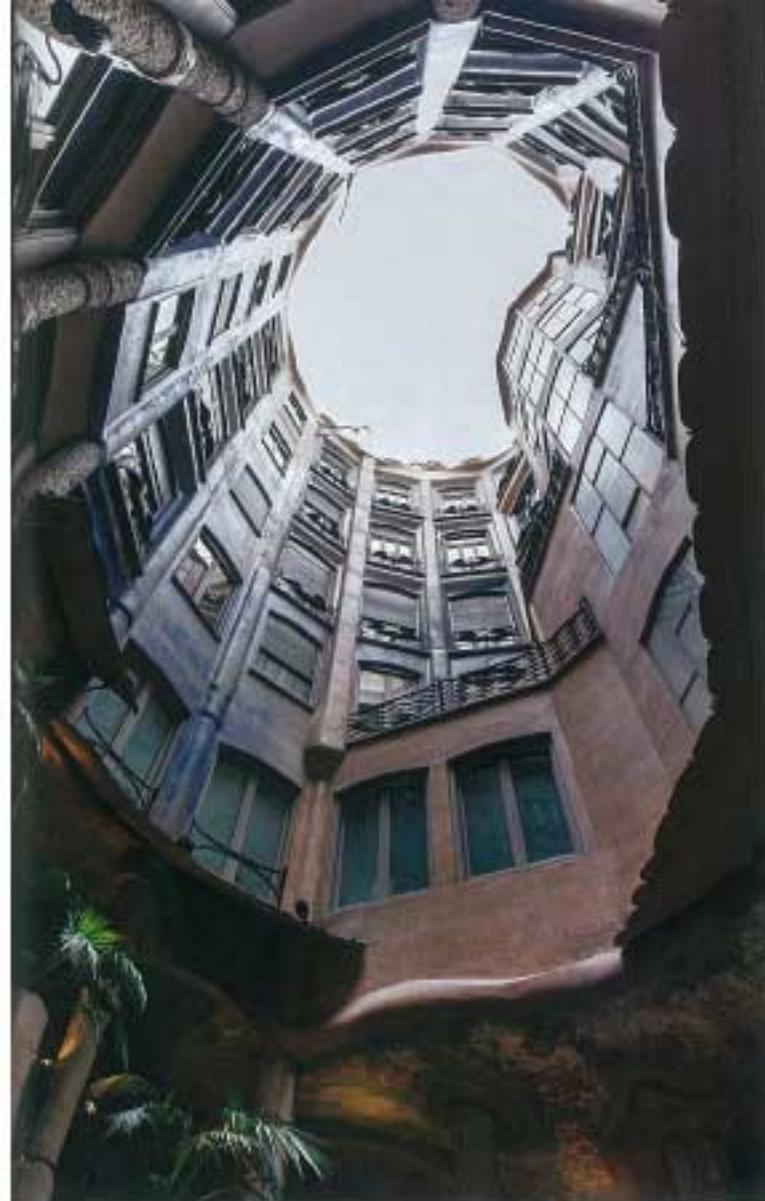
「カサ・ミラ」は波打つような石積み面のファサードから、「ラ・ベドレラ（石切り場）」とも呼ばれています。実際に建物の荷重を支えているのは外壁ではなく、鉄筋の入った石の梁やレンガ壁で、そのためにより自由な造形が可能になりました。
